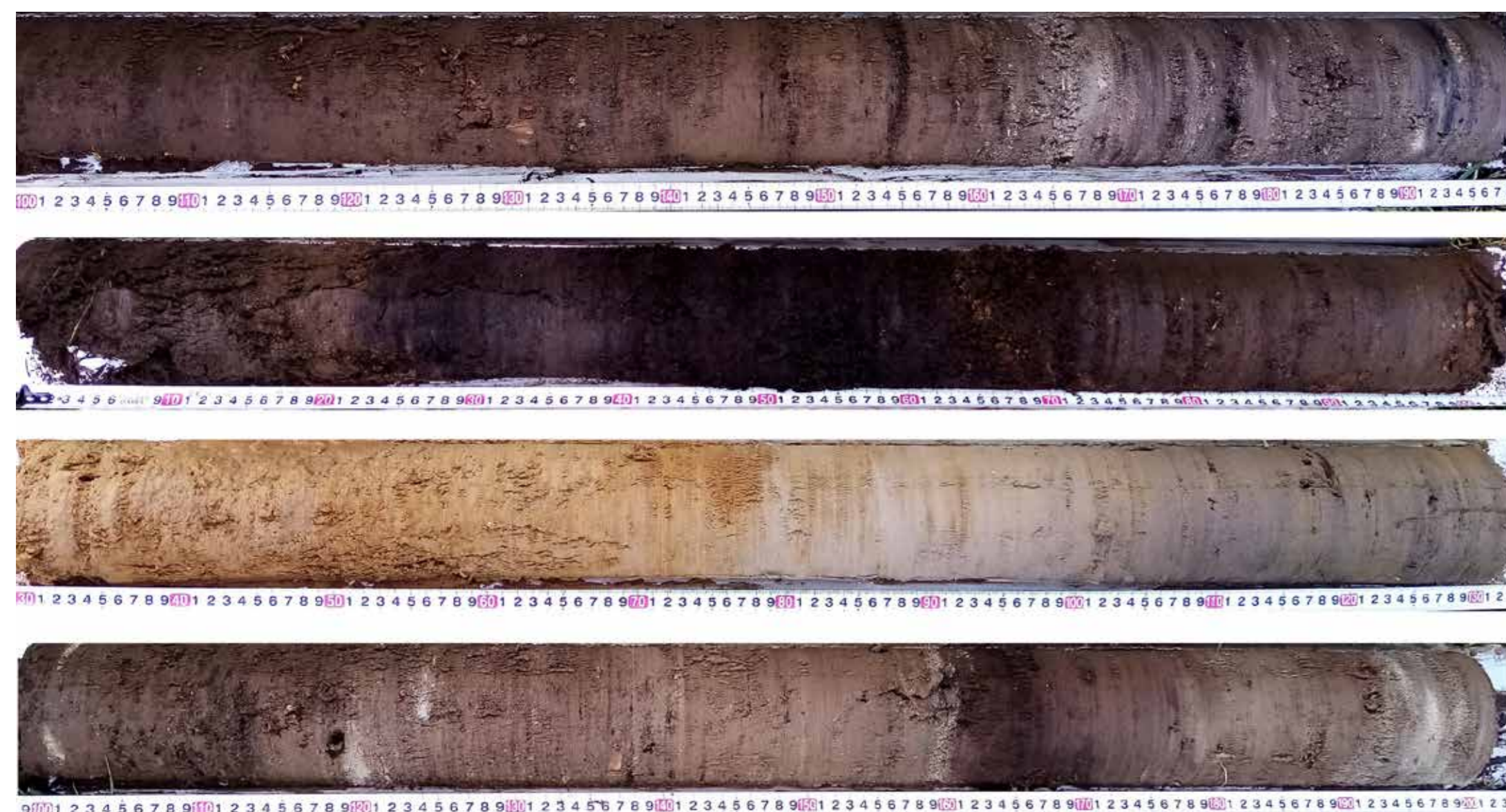
Fig. 2. Carottes prélevées pour études en laboratoire. Sont mis en évidence des niveaux de tourbe plus ou moins décomposée, des niveaux argileux parfois organiques, et de fins niveaux de sables et graviers correspondant certainement à des dépôts de crues.
