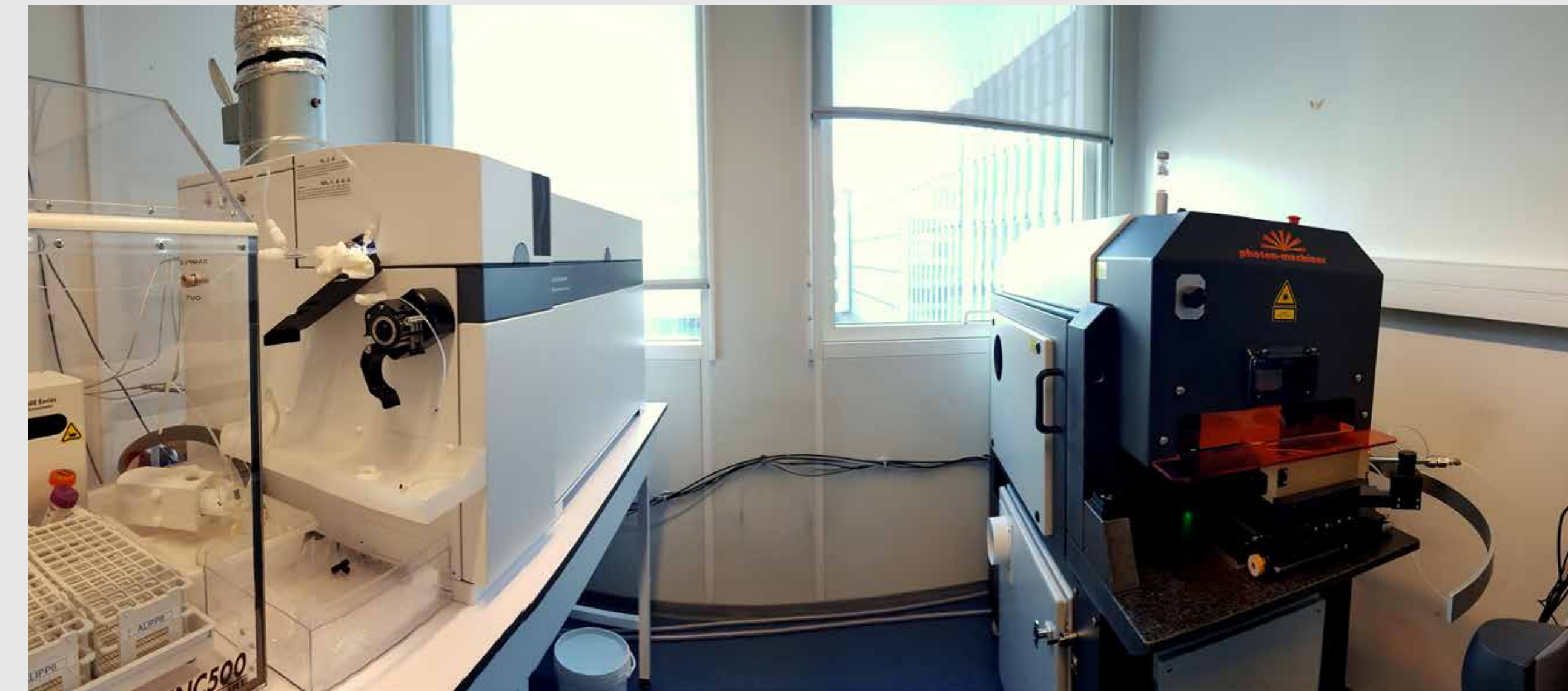
Dispositif de LA-ICP-MS de la plateforme ALIPP 6 (plateforme d'analyse géochimique de l'ISTeP UMR 7193, Sorbonne Université Paris). A droite : dispositif d'ablation laser ; à gauche : dispositif d'acquisition en ICP-MS. © Marie Imbeaux
