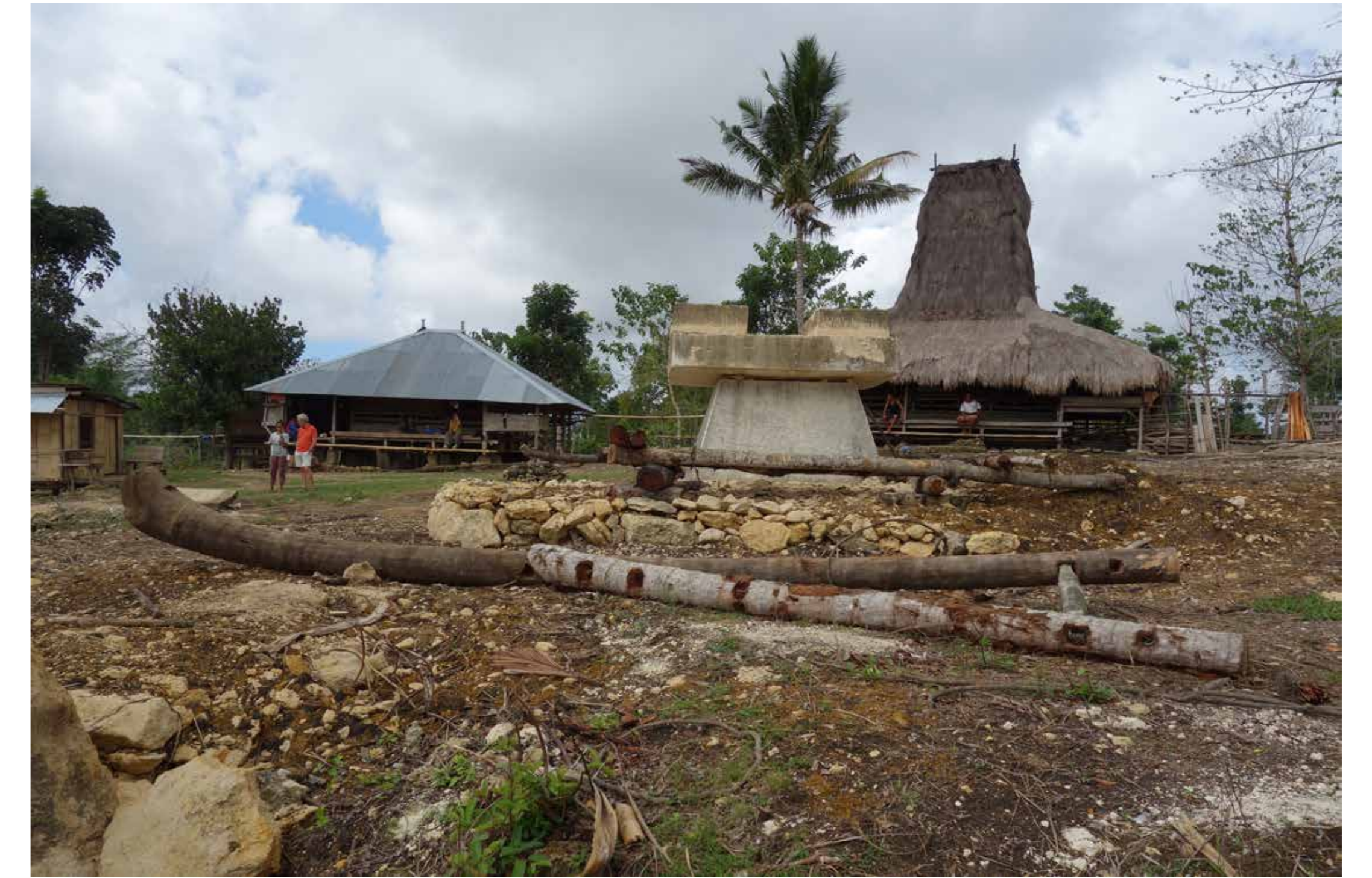
Fig. 4 : Village de Pu'u Nu'u Rara (district Lolli). Au premier plan, vue du traîneau ayant servi au transport de la ciste en pierre et de sa dalle de couverture situées au second plan. Ce traîneau est constitué de deux troncs assemblés à l'aide d'une cheville et d'une traverse en bois fixées dans des mortaises. Plusieurs autres mortaises ont également été aménagées, certaines à l'arrière pour fixer les cordes des tireurs, d'autres vers le centre de l'attelage pour accrocher les liens maintenant les blocs en place. Noter l'avant surélevé du traîneau. © Anthony Denaire, 2018
