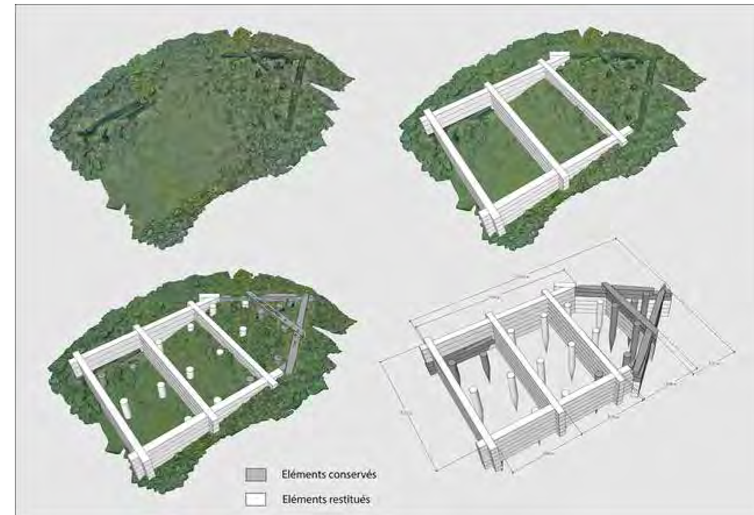
Pontoux (71), pont romain. Photogrammétrie (en haut à gauche) et restitution de la pile 3 à l'issue de la campagne de fouille 2020 (© DAO P. Moyat).
